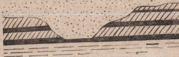
Hình 24 Địa tầng ngậm than bị xói dội
