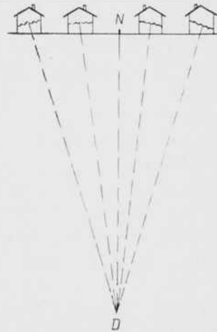
H. 220 Cách xác định độ sâu của nguồn động đất: N — tâm ngoài; D — tâm dưới
