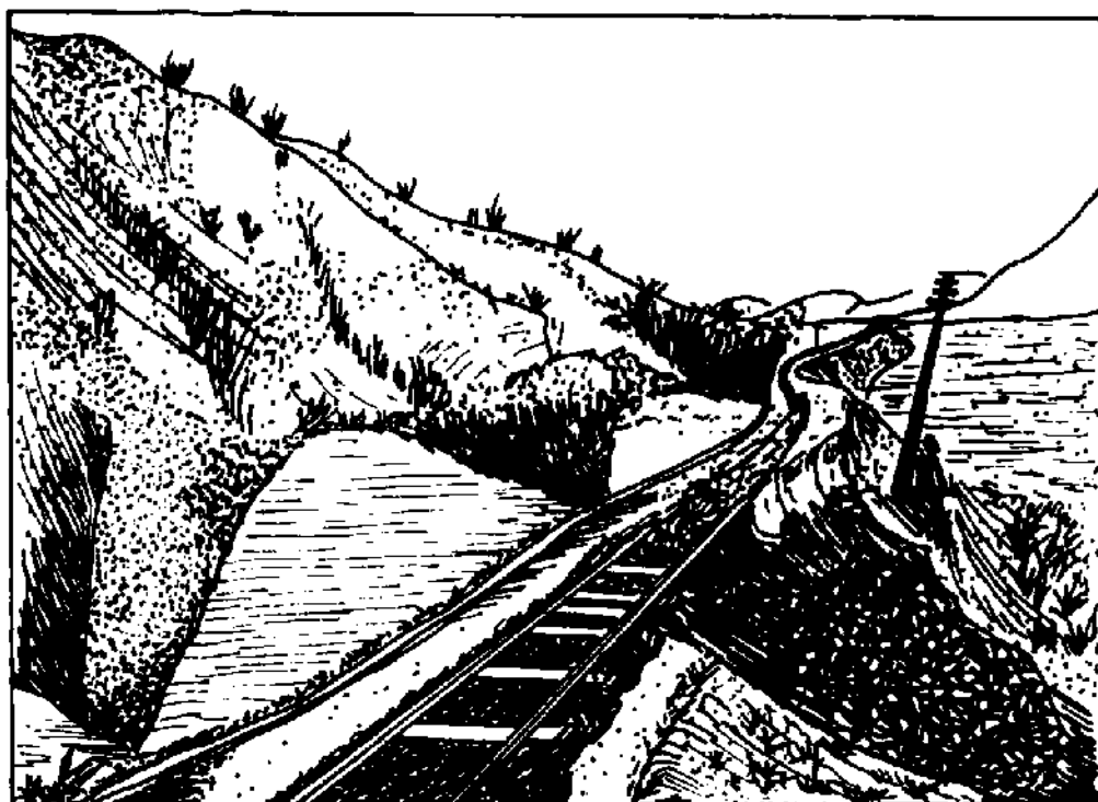
Hình 1.4. Trượt sườn (tuyến đường sắt Hà Lào)
